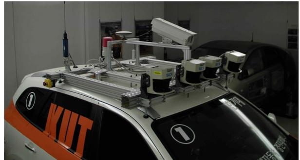
그림 3. 지붕에 설치된 각각의 센서.
