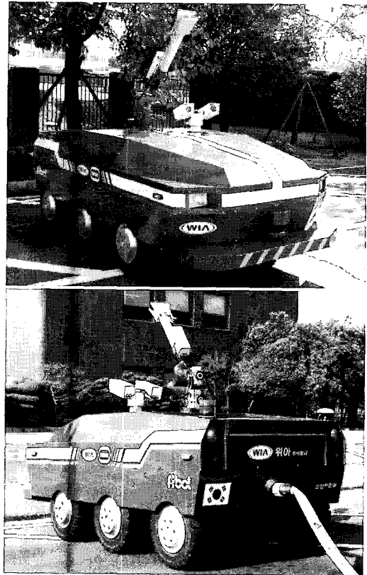
그림 5. 개발된 실외화재진압 및 인명구조 로봇. Fig. 5. Developed fire-fighting and rescue robot for outdoor environment.
