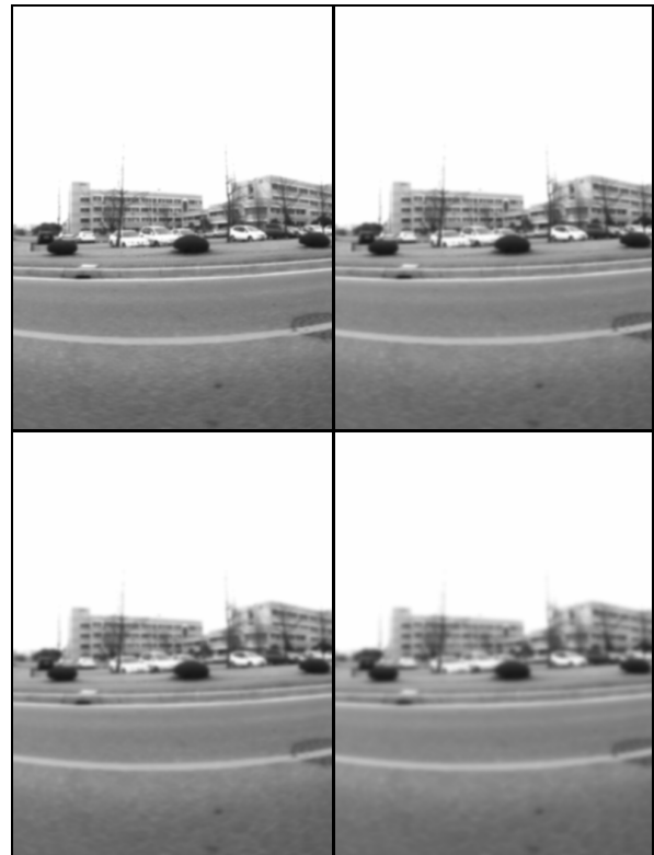
그림 1. 스케일 공간(scale space)의 예 (가우시안의 분산을 변화시키면서 얻은 영상)
