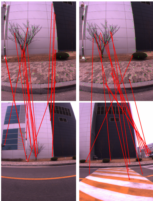
그림 3. 잘못된 투표 결과의 예 (좌) 매칭되어야 하는 영상 (우) 실제로 매칭된 영상
