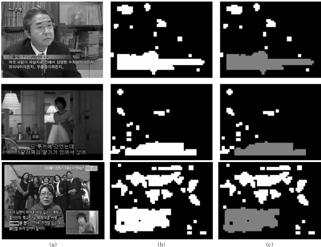
그림 3 (a) 자막이 삽입 된 다양한 영상들. (b) 블록 가중치를 이용하여 추출한 자막 후보군. (c) 최종 자막 영역 추출
