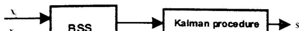
그림 1. 제안된 2개의 마이크로폰을 이용한 음성개선 방법 [x: 열화된 음성 신호, s: 복원된 위 음성 신호] 우리는 각각의 알고리즘이 열화된 음성에 적용 전 후
