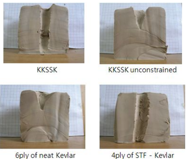
그림 8. Trauma depth of different specimens
